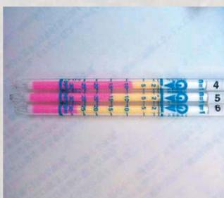
▲アンモニアを検知すると、検知管が紫色に変わる。
