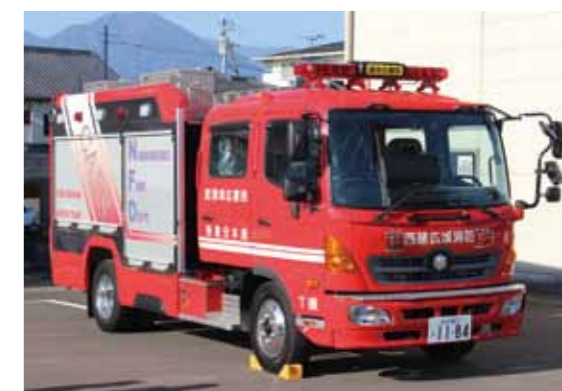
同車には、圧縮空気泡消火装置（CAFS装置）が設備されており、従来より少量の水で効率よく消火活動が行えます
