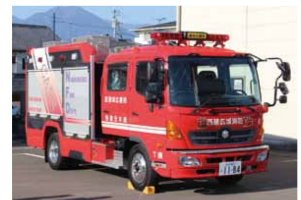
同車には、圧縮空気泡消火装置（CAFS装置）が設備されており、従来より少量の水で効率よく消火活動が行えます
