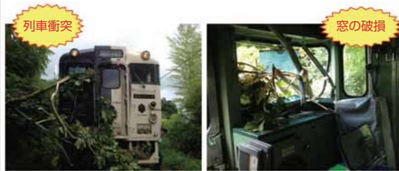
JR九州用地外からの倒木発生事例
